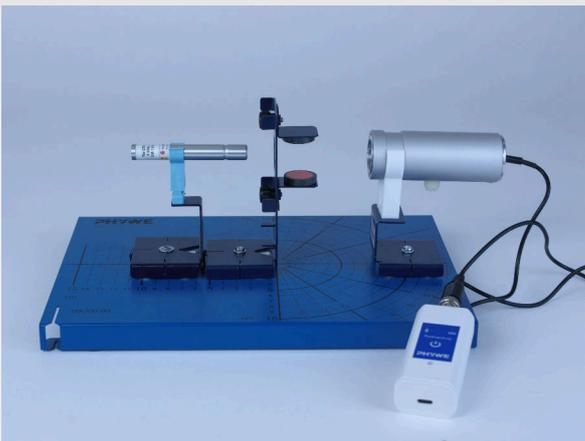
Экспериментальная установка с отклоняющими магнитами и детектором в положении  $0^\circ$
