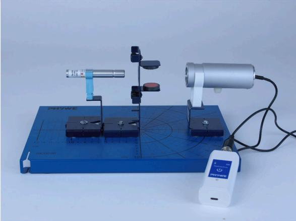
Экспериментальная установка без материала-поглотителя на пути луча
